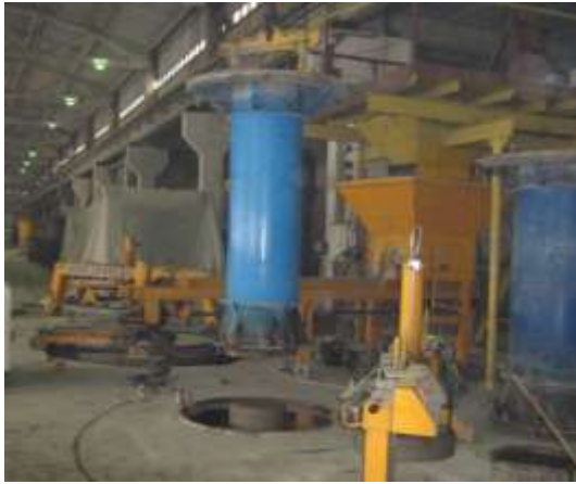
Рис. 1. Виготовлення труб \varnothing 400 мм методом вертикального вібропресування; сталевібробетонна труба \varnothing 400 мм, після набору міцності.
