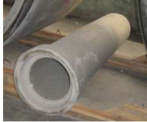
Рис. 1. Виготовлення труб \varnothing 400 мм методом вертикального вібропресування; сталевібробетонна труба \varnothing 400 мм, після набору міцності.
