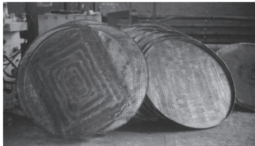
Рис. 8. Вироби, отримані ротаційним відбортуванням круглих листових заготовок
