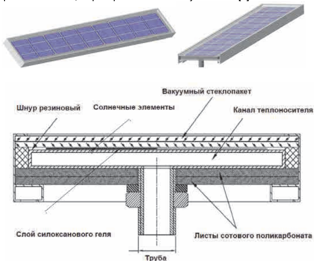
Рис. 1. Общий вид теплофотоэлектрического приёмника и его поперечное сечение
