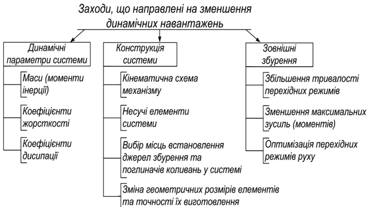
Рис. 1. Заходи направлені на зменшення динамічних навантажень у елементах механізму підйому вантажу.
