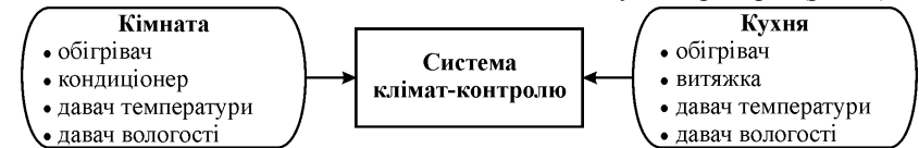
Рис. 1. Складові підсистеми клімат-контролю
