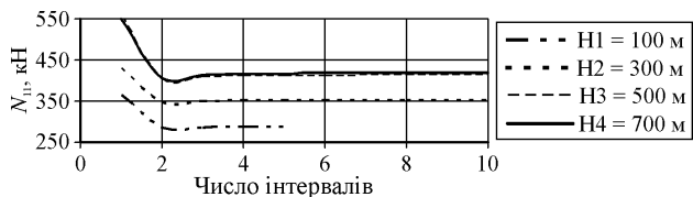
Рис. 2. Залежність максимальних сил пружності у довгій вітці каната від числа ділянок
