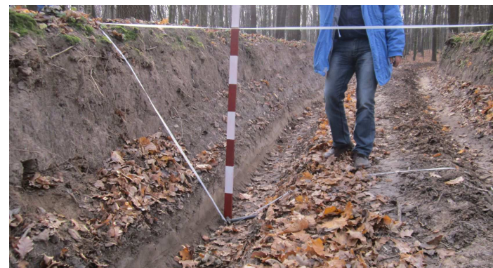
Рис. 2. Поперечний профіль дороги в точці Т7
