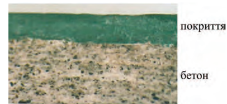
Рис. 4. Структура контактної зони гідрофобізатор – бетон (1X100)
