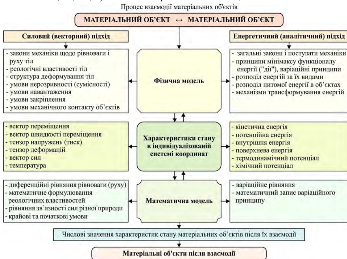
Рис. 1. Структурна схема силового та енергетичного підходів у моделюванні та визначенні стану матеріальних об'єктів
