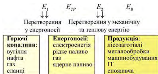
Рис. 3. Схема формування енергетичних втрат під час перетворення горючих копалин у додаткову продукцію: E_1 – енергетичні втрати під час перетворення горючих копалин у енергоносії; E_{ТР} – енергетичні втрати, зумовлені необхідністю транспортування енергоносіїв до місця їх споживання; E_2 – енергетичні втрати під час вироблення механічної енергії із енергоносіїв – для технологічних потреб; E_B – теплові втрати у виробничих процесах перероблення сировини у продукцію.
