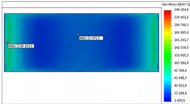
Рис. 9. Візуалізація критеріїв міцності за Мізесом
