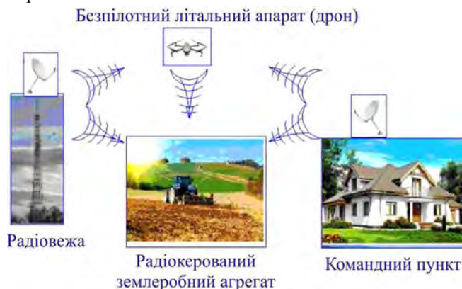
Рис. 4. Спеціалізований сільськогосподарський комплекс автоматизованого керування землеробною технікою із використанням пульта керування / Specialized agricultural complex of automated control of tillage equipment with a remote control
