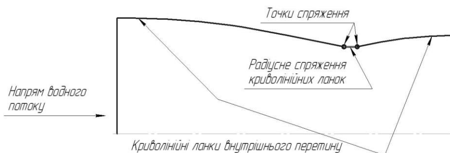
Рис.2. Внутрішній перетин пропонованої конструкції насадок для фонтанів
