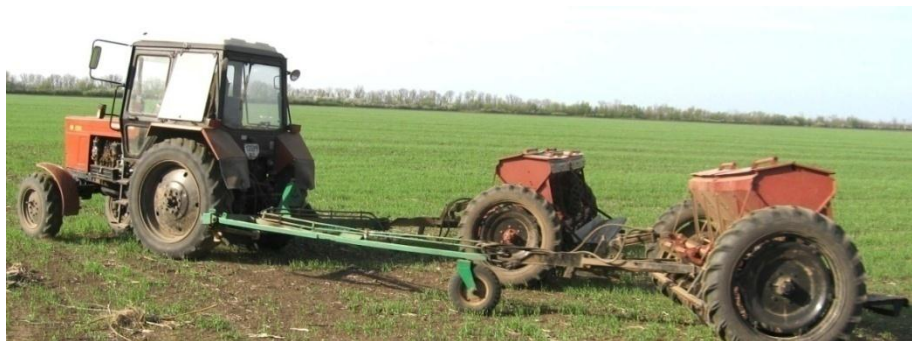
Рис. 3. Напівнавісна зчіпка СН-7,2 і двомашинний посівний агрегат на її основі.
