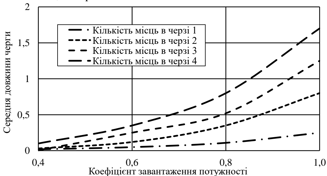
Рис. 3. Зміна середньої довжини черги автомобілів в залежності від коефіцієнта завантаження потужності та кількості місць в черзі
