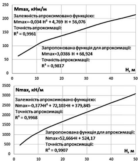
Рис. 1. Залежність максимальних згинаючих моментів та повздовжніх сил в обрці від глибини її залягання, за результатами розв'язаної задачі в роботі [5]
