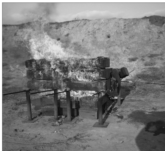
Рис. 3. Полігонні вогневі випробування горіння штабелю дерев'яної укупорки [9]
