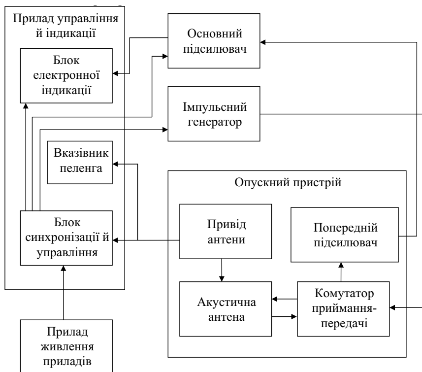
Рис. 3. Схема електричних з'єднань гідроакустичною станцією з антеною, що опускається
