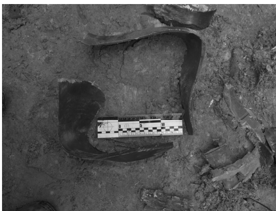
Рис. 9. Характер руйнування центральної частини ствола міномета при натурному підриві двох мін в каналі ствола
