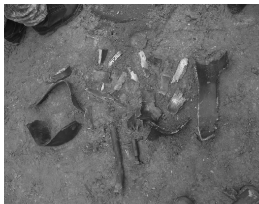
Рис. 9. Характер руйнування центральної частини ствола міномета при натурному підриві двох мін в каналі ствола
