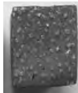
зразок із захисним покриттям
