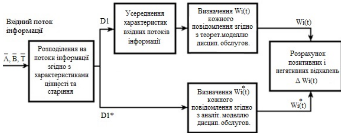
Рис. 1. Схема дослідження впливу характеристик вхідного потоку інформації на точність визначення W_i(t)
