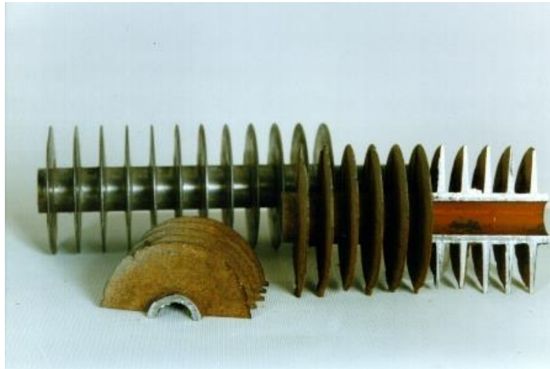
Рис. 3. Зразки біметалевих теплообмінних поверхонь теплообмінників: на передньому плані фрагмент поверхні теплообмінника після 8 років експлуатації, на задньому плані – зразок, що не був у експлуатації
