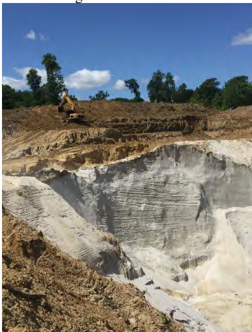
Рис. 3. Уступ розкривної товщі і робочий уступ кар'єру Давидів-1 Fig. 3. Overburden bench and mine wall of Davydiv-1 quarry
