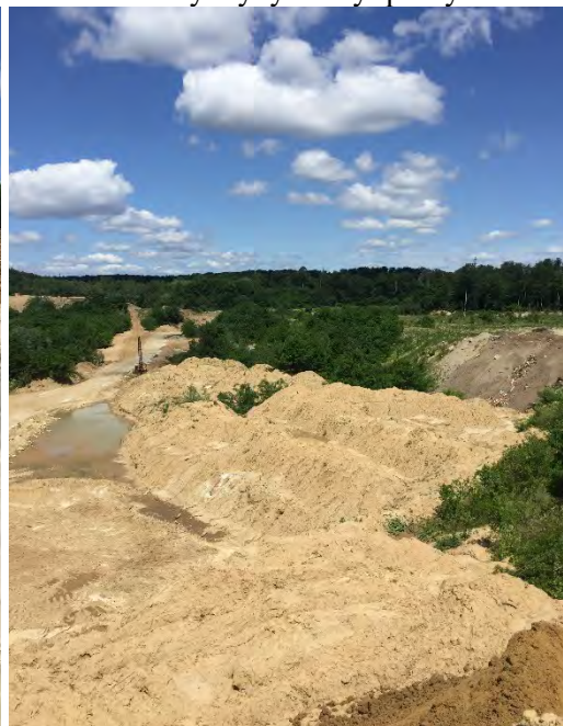
Рис. 4. Валоподібні і плоскі внутрішні відвали кар'єру Давидів-1 Fig. 4. Shaft-shaped and flat interior dumps of Davydiv-1 quarry
