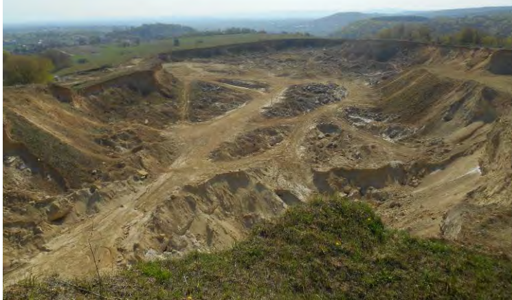
Рис. 8. Південна частина Винничківського кар'єру, оточена чітко виразними уступами, зліва на задньому плані – антропогенний останець Fig. 8. Southern part of Vynnychky quarry, surrounded by clearly defined ledges, at the background on the left is anthropogenic butte
