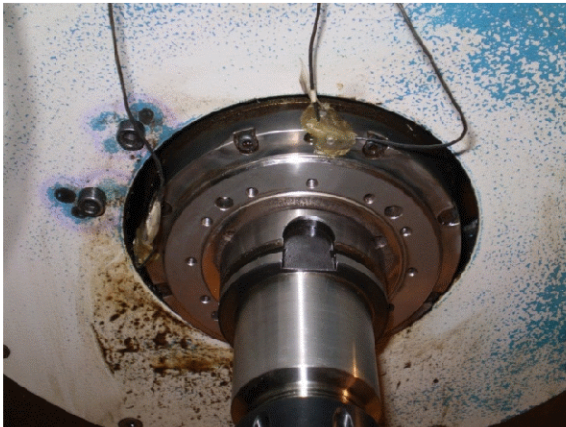
Рис. 1. Схема установки датчиков віброускорення AP 2019 і її реалізація на оброблюваному центрі мод. 500V/5.
