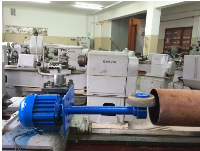
Рис. 1. Пристрій для обробки отвору циліндра абразивним інструментом
