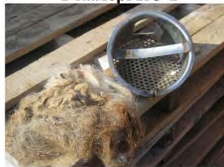
Рис. 10. Удосконалений проточний фільтр з фільтрувальним елементом
