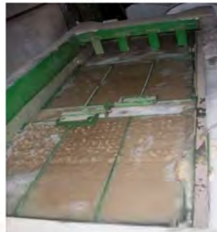
Рис. 6. Промивання вовни на МВМ-0,24 з поетапним віджиманням
