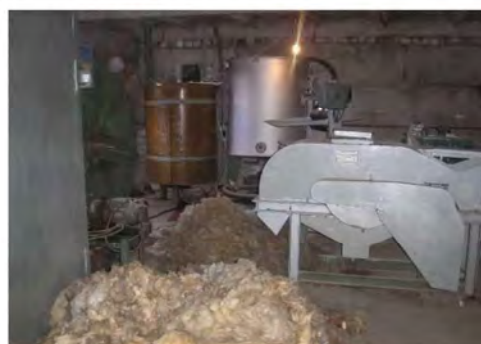
Рис. 2. Елементи технологічного модуля первинної переробки вовни ТМ ПОВ-8,0
