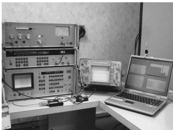
Рис. 3. Установка для дослідження метрологічних характеристик калібратора бінарних СНС
