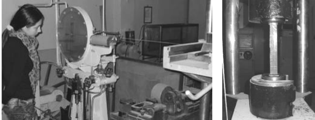
Рис. 7. Випробування плоских зразків на розрив на машині УВМ-50
