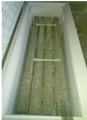
Рис. 2. Морозильна камера Vestfrost VT 407 з дослідними зразками
