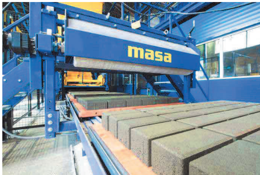
Рис. 1 Загальний вигляд технологічної лінії моделі MASA – 9 XL.1 на виробництві ТМ «МІЙ ДВІР»
