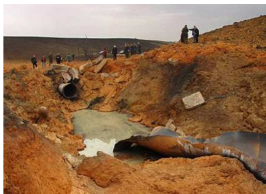
Рисунок 1 – Наслідки аварії на газопроводі, спричинені витокami газу
