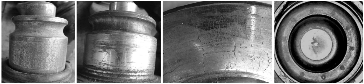
а – загальний знос опори і підтінги на біговій доріжці замкового кулькового підшипника кочення ; б – загальний знос опори та тріщини на наплавленій поверхні великого підшипника ковзання; в – тріщини і дрібне викришування наплавленого шару упорного торця лапи; г – утворення на упорному торці шарошки притертої канавки, що відповідає поверхні торця лапи
