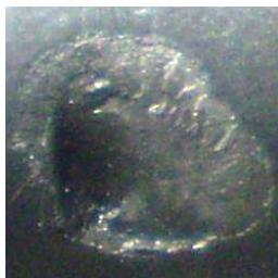
Рисунок 6 – Характерний вигляд локального втомного контактного руйнування поверхні бігової доріжки, утвореного ростом системи тріщин від підповерхневого дефекту в цементованому шарі \times 10\mu
