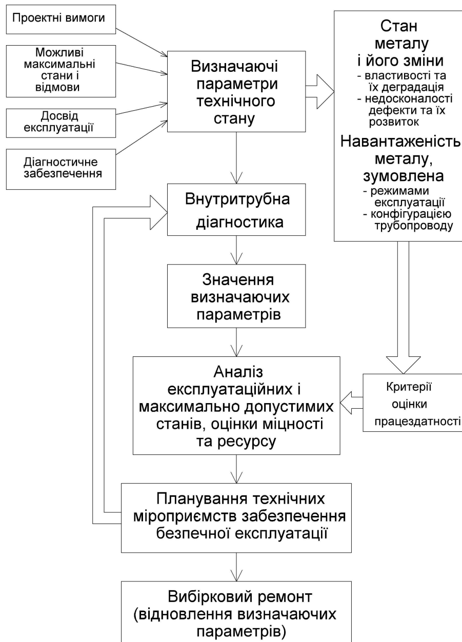
Рисунок 1 – Схема реалізації концепції безпечної експлуатації потенційно небезпечних інженерних споруд значної довжини (магістральних трубопроводів)
