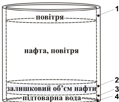
Рисунок 1 – Схема вирізання зразків з різних ділянок (1, 2, 3, 4) нафтохранища
