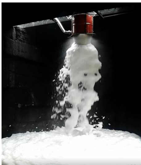
Рисунок 8- Приклади стаціонарного встановлення функціональної моделі генератору піни високої кратності
