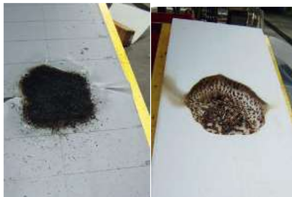
Рисунок 1 – Результати випробування покриття ПВХ на ізоляції EPS зі скловолоконном між шарами за методом 1.
