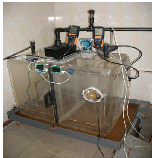
Рисунок 2 – Загальний вигляд лабораторного стенда для експериментальних досліджень екрануючої здатності водяних завіс у вигляді суцільного потоку, що спадає зверху донизу від проникнення диму, оксиду вуглецю (IV) та оксиду вуглецю (II)
