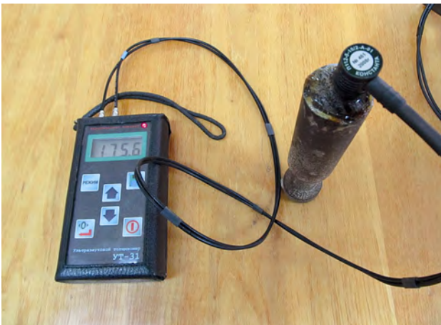
Рис. 3. Вимірювання довжини стінного репера ультразвуковим дефектоскопом УТ-31
