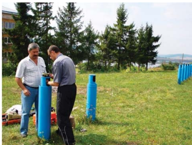
Дослідження стабільності інтервалів фазової ділянки Бережанського еталонного базису виконують ст. викл. І. Я. Покотило та асист. В. Л. Тарнавський. 2013 р.
