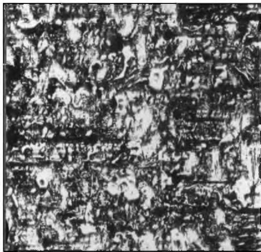
Рис. 2. Микроструктура наплавленного плазменным методом слоя «Т-Термо» \times 200
