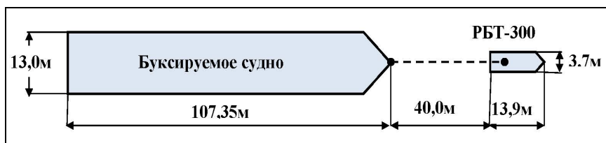
Рис.1. Схема буксирной системы.
