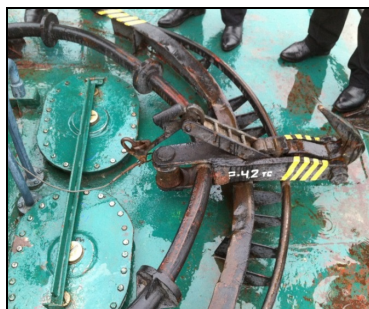
Рис.10. Схема установки ограничителей на буксирной дуге безопасного движения гака.
