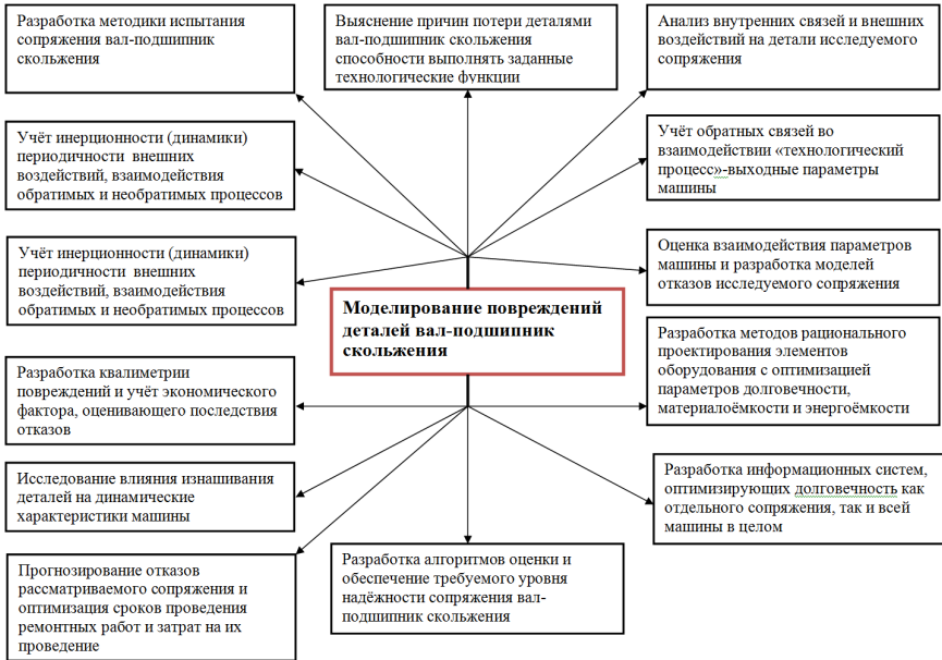
Рисунок 1. Направления использования моделирования повреждений деталей вал-подшипник скольжения
