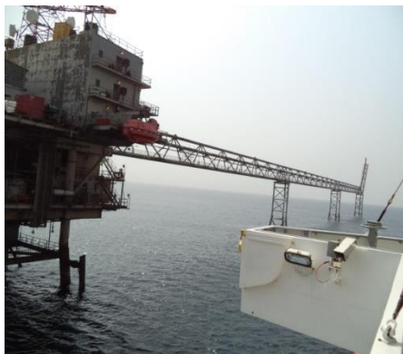
Рис. 1 Багатофункціональне судно підтримки у комбінації з нафтовидобувною платформою
