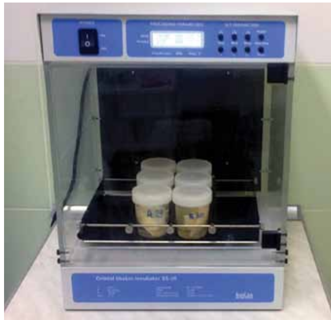
Рис. 1. Девитализация аллогraftов с использованием орбитального шейкера-инкубатора ES-20 (BioSan, Латвия)
