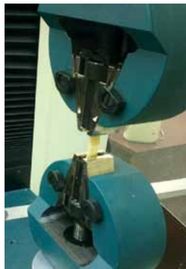
Рис. 3. Прочностные испытания аллогraftов с использованием испытательной разрывной машины Tinius Olsen H150KU (Tinius Olsen, Великобритания)
