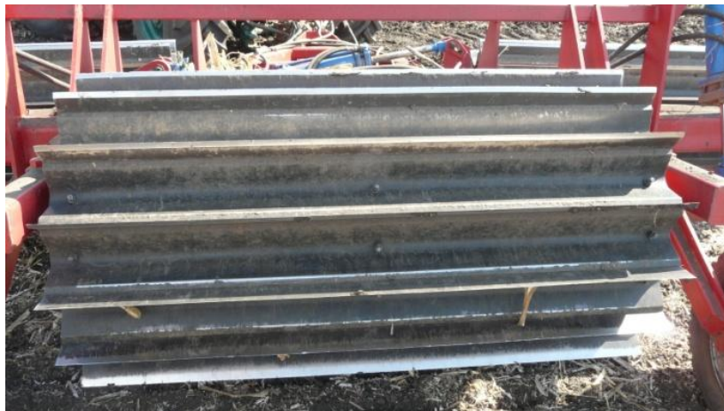
Рис. 3 – Робочий орган котка-подрібнювача
