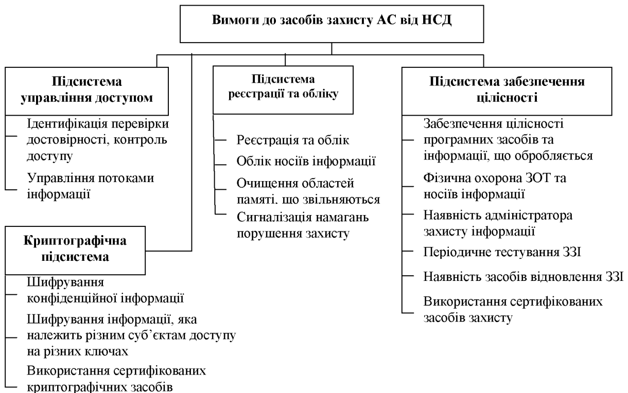
Рис. 1. Таксономія вимог до засобів захисту АС від НСД (де: ЗОТ – засоби обчислювальної техніки; ЗЗІ – засоби захисту інформації)
