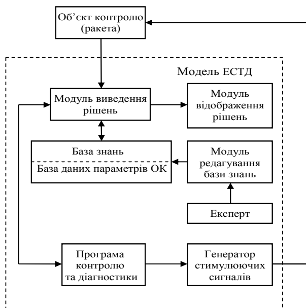
Рис.1. Структура традиційної експертної системи технічної діагностики
