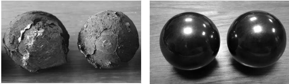
Рис. 2. Керамічні заготовки після спікання (а) й готові кулі (б).
