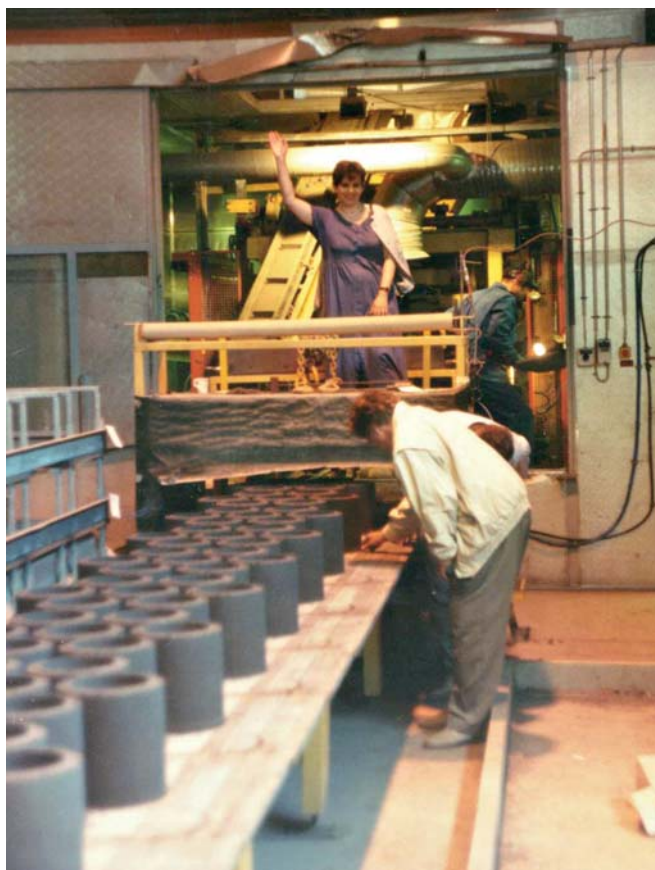
Рис. 5. 1982 р., м. Турку, Фінляндія. Виробництво димових труб з коррозійностійкого шлаколузного бетону
