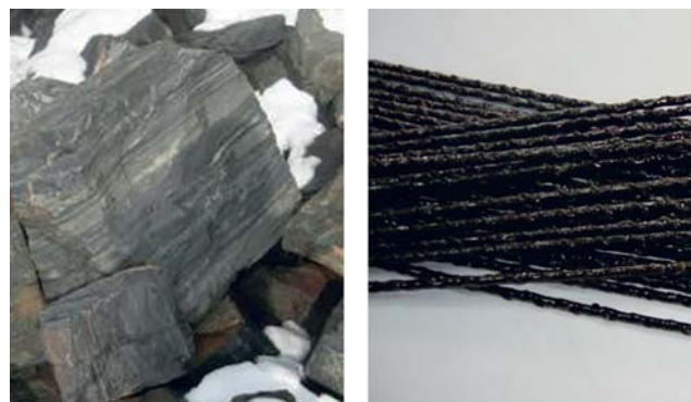
Рис. 4. а – базальт в природном виде, б – базальтовая арматура
